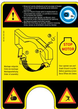
Dieser Aufkleber wird an der oberen Wand der Mahlraum eingefügt. Die Kleber erinnert den Benutzer regelmäßig die Spannung auf der Messerbolzen zu überprüfen. Die Aufkleber beschreibt die Methode der Demontage und Montage des Sieb und warnt den Anwender zum Ausschalten des Motors vor dem Sieb geöffnet wird Darüber hinaus warnt der Aufkleber den Benutzer vor der Gefahr von Schnittwunden an den Händen und vor der Gefahr von herausfliegender Schnipsel beim Öffnen des Siebes.
