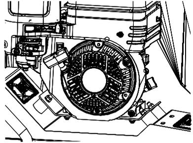
Ist die Klemmkraft beseitigt, kann die Messerwelle von der Motorwelle geschoben werden. Nehmen Sie die Messerwelle zwischen den beiden Messerplatten mit ihrem Kern und halten Sie sie hoch. Schieben Sie nun den Motor nach links, bis die Kurbelwelle vollständig aus der Nabe der Messerwelle herausragt. Nun kann die Messerwelle aus der Mahlkammer entnommen werden.
