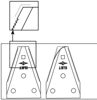
Andererseits ist für die Leistung und die Geschwindigkeit dieses primären Schnitts auch die Form der Messerspitze von wesentlicher Bedeutung. Der Winkel der **Messerspitze** bestimmt das Maß, mit dem das Holz in die Hackelkammer hineingezogen wird. Wenn dieser Winkel durch Verschleiß abgerundet ist, müssen die Messer umgedreht oder ausgetauscht werden. („Siehe § 11.3.4 Messer umdrehen oder ersetzen“ auf Seite 37“)
