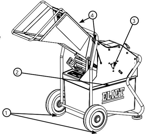
Die zu schmierenden Stellen immer mit Kriechöl oder einem Spray auf MoS<sub>2</sub>-Basis besprühen, um altes Schmiermittel zu lösen und Korrosion aufzulösen.
