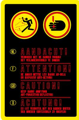
Dieser Aufkleber wird auf den Schutzschild in der Einfüllschacht eingefügt. Er weist ausdrücklich auf die Verletzungsgefahr für die Hände hin, die beim Holzhäckseln grundsätzlich entsteht. Dies sind zwei Risiken der Häckseln der von den Schutzschild Zurück gehalten werden. Er erinnert den Benutzer daran, wie er sicher mit dem Häcksler arbeiten kann. Es ist verboten, mit den Händen hinter das Schutzschild zu greifen!
