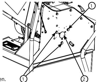
Entfernen Sie nun die Motorbefestigungsplatte vom Rahmen. Dazu die vier M8-Schrauben vollständig lösen. Der Motor mit seiner Motorplatte ist nicht mehr am Rahmen befestigt.
