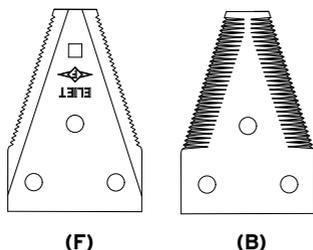
Wie in § 11.3.4 "Kontrolle der Messer" beschrieben, sind eine scharfe Klinge und ein korrekter Schnittwinkel für eine effiziente Zerhäckseln von wesentlicher Bedeutung. Um diese beiden Eigenschaften realisieren zu können, müssen die Messer korrekt geschliffen werden.
