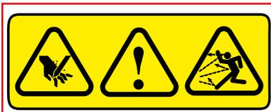
Diese Symbole stehen auf der linken Seite den Einfülltrichter. Dieses Piktogramm warnt vor der Gefahr von Schnittverletzungen und herausfliegendes Häckselgut. Es ist verboten, mit den Händen hinter das Schutzschild zu greifen!.
