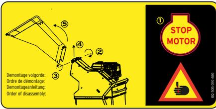
Dieser Aufkleber wird an der oberen Wand der Einfülltrichter eingefügt. Die Art und Reihenfolge der Demontage von den Einfülltrichter wird dargestellt. Den Einfülltrichter ist zerlegbar für den Transport und für kompakte Lagerung der Maschine. Es erinnert den Benutzer zum Ausschalten des Motors vor den Trichter zu zerlegen. Nach der Demontage besteht ein erhöhtes Kontaktisiko mit den Messern und dadurch eine erhöhte Gefahr von Schnittwunden. (Artikel nr.: BQ 505 010 480)
