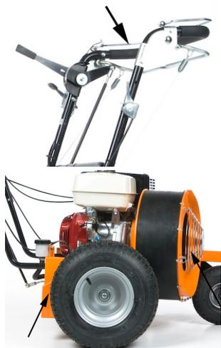
**Levier de point mort :** Ce levier se trouve sur la fourche et doit être enfoncé pour pouvoir démarrer le moteur. Le moteur s'éteint dès que ce levier est relâché.
